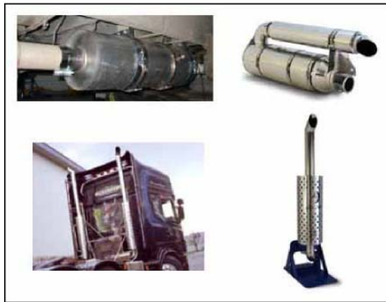
Figura 4.1. – Filtros de partículas en diferentes tipos de vehículos: autobuses, camiones, ...
