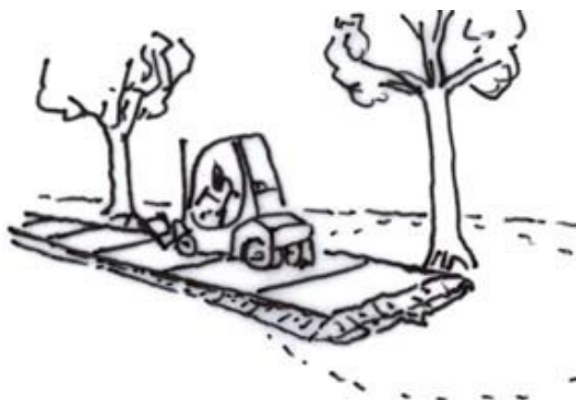
Fig 3. Protección al paso de maquinaria por encima del área de afectación
